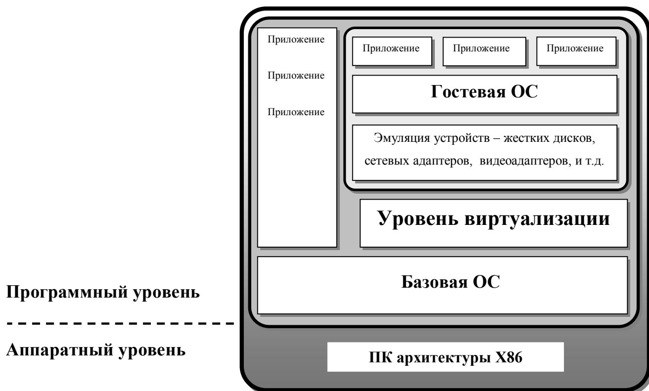
Рис. 4. Модель виртуальной машины на основе архитектуры x86
